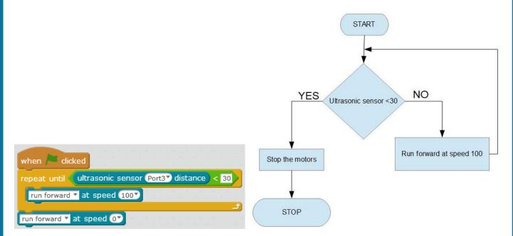
El robot cuando está lejos de la pared avanza (distancia que detecta el sensor de ultrasonidos > 30 cm). En cambio, cuando se acerca a la pared, a una distancia menor de 30 cm, se detiene.
