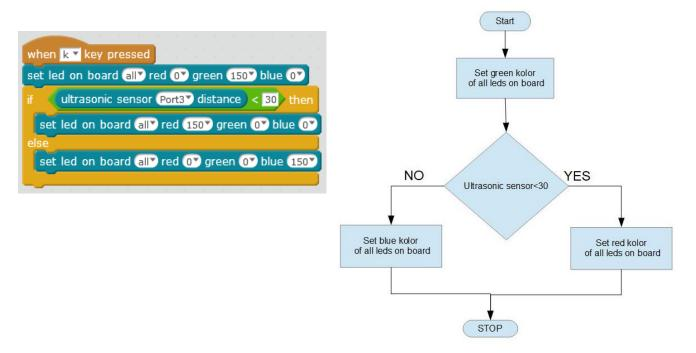
Antes de presionar la tecla "K", ves colocando el robot a una distancia diferente de la pared. Prueba el programa varias veces. ¿Puedes ver el color verde, se encienden los leds de color verde? No. ¿Qué podemos
