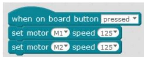
Los bloques que controlan los motores, nos ofrecen distintas velocidades a elegir. Incluso podemos nosotros escribir manualmente la velocidad que deseemos, dentro del intervalo de 0 a 255 rpm.
